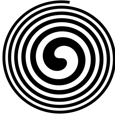
Obrázek 4.1: Interferenční obrazec svazku LG_0^1 a rovinné vlny. Vykresleno z rovnice (4.1) pro n = 0 , \psi = 0 a k = 2R .
