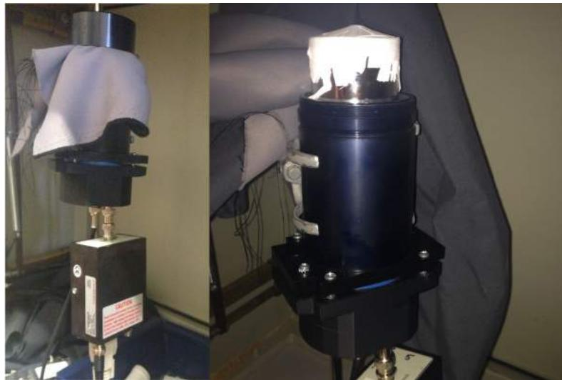
Obrázek 4.5: Výsledná měřící aparatura pro měření s fotonásobičem. Vpravo je sundán pohlcovač externích fotonů.
