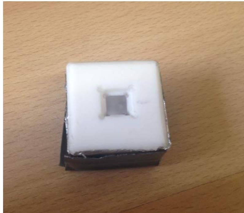
Obrázek 4.6: Výsledný teflonový reflektor pro měření s křemíkovými fotonásobiči.
