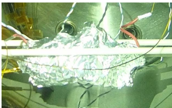
Obrázek 14: Štít proti ztrátám tepla zářením z alobalu těsně přitisknutého k topné trubičce
