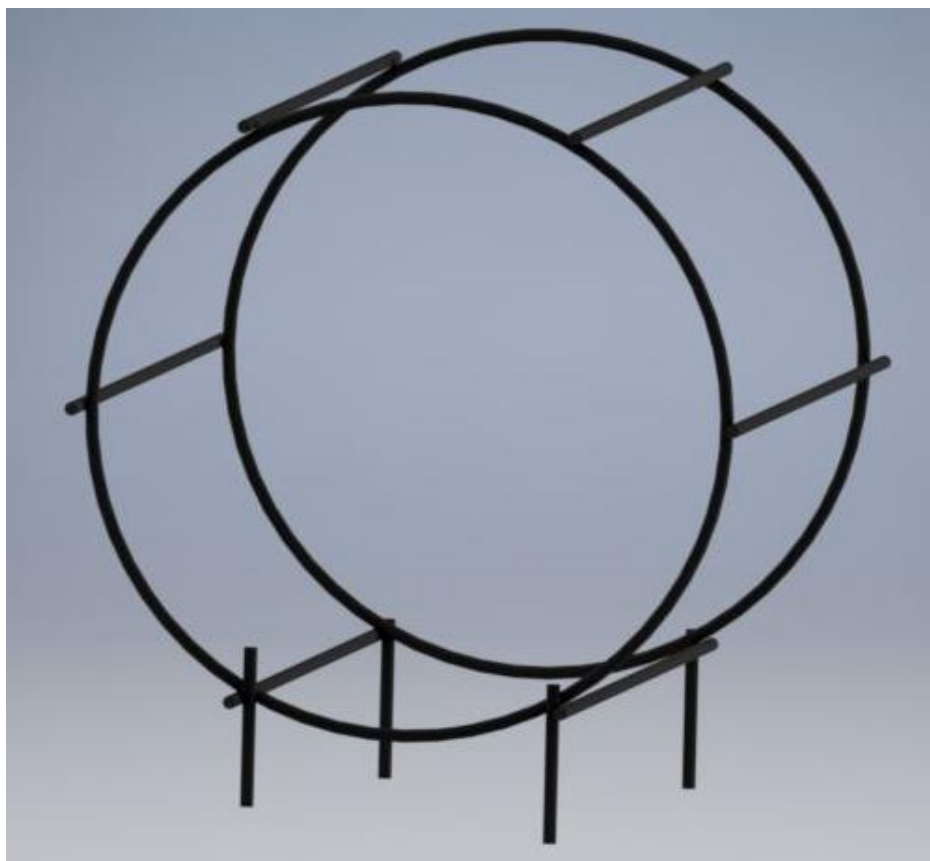
Obrázek 30: Vizualizace návrhu držáku pro izolaci proti ztrátám tepla zářením.
