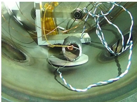
Obrázek 10: Uložení topné trubičky na destičce z oxidu hlinitého.
