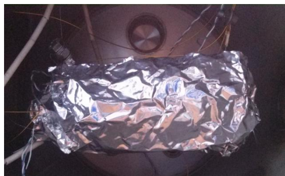
Obrázek 15: Vzdálený alobalový štít proti ztrátám tepla zářením. Rozměry štítu jsou: délka 12 cm a průměr 6 cm.
