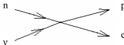
Obr. 2 Fermiho čtyřvertex pro \beta rozpad neutronu.
