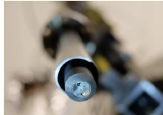
Obrázek 2.3: Hlavice VRCP s jednou ball-pen a jednou Langmuirovou sondou. Použito se svolením Jakuba Seidla.
