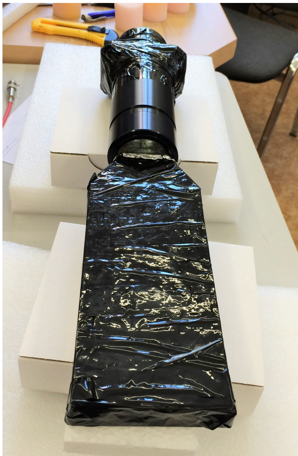
Obrázek 2.2: Sestava scintilátor-světlovod-fotonásobič-patice po přelepení izolační páskou.
