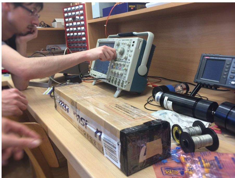
Obrázek 2.3: Jeden scintilační modul během testování odezvy.
