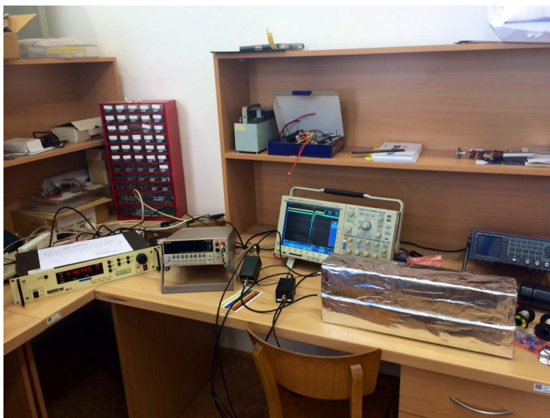
Obrázek 3.2: Fotka aparatury detektoru. Na obrazovce osciloskopu je zaznamenaný prelet kozmického miónu.
