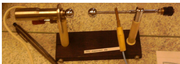
Obrázek 2.6: Fotografie jiskřiště použitého při měření napětí zdroje.
