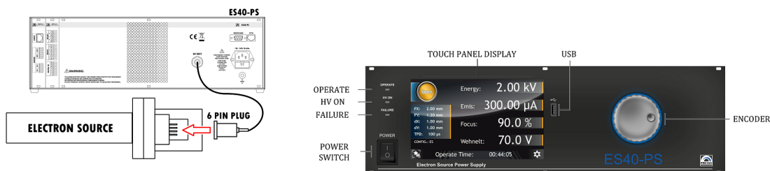
Obrázek 4.1: Vlevo: Schéma zapojení zdroje elektronů ES40-PS. Vpravo: Ukázka předního ovládacího panelu stanice ES40-PS. Převzato z [14].
