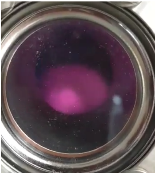
Obrázek 2.5: Pozorovaný fialový doutnavý výboj při tlaku zhruba 100 Pa.
