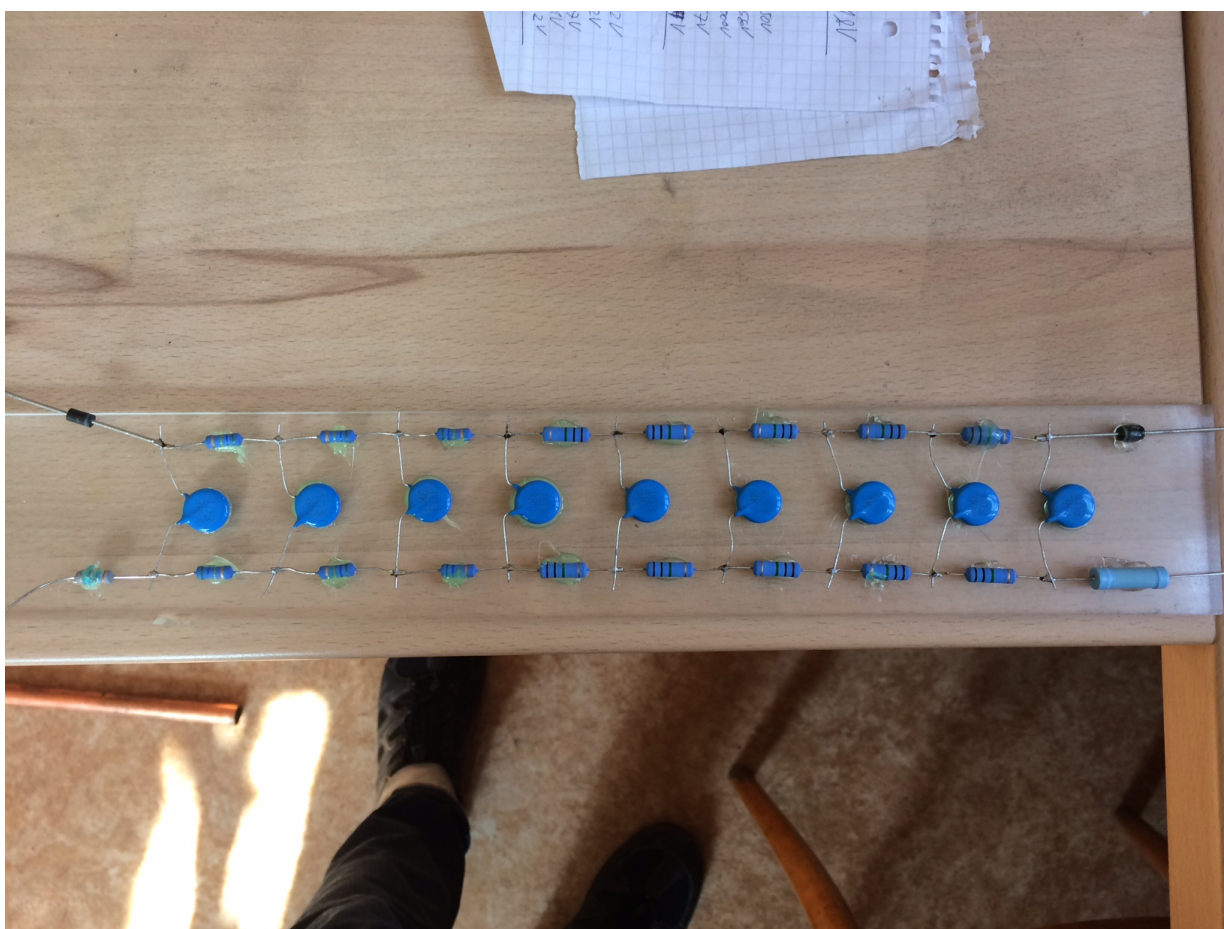
Obrázek 4.3: Zapojení kondenzátorů a rezistorů na plexiskle, tvořící "žebřík".
