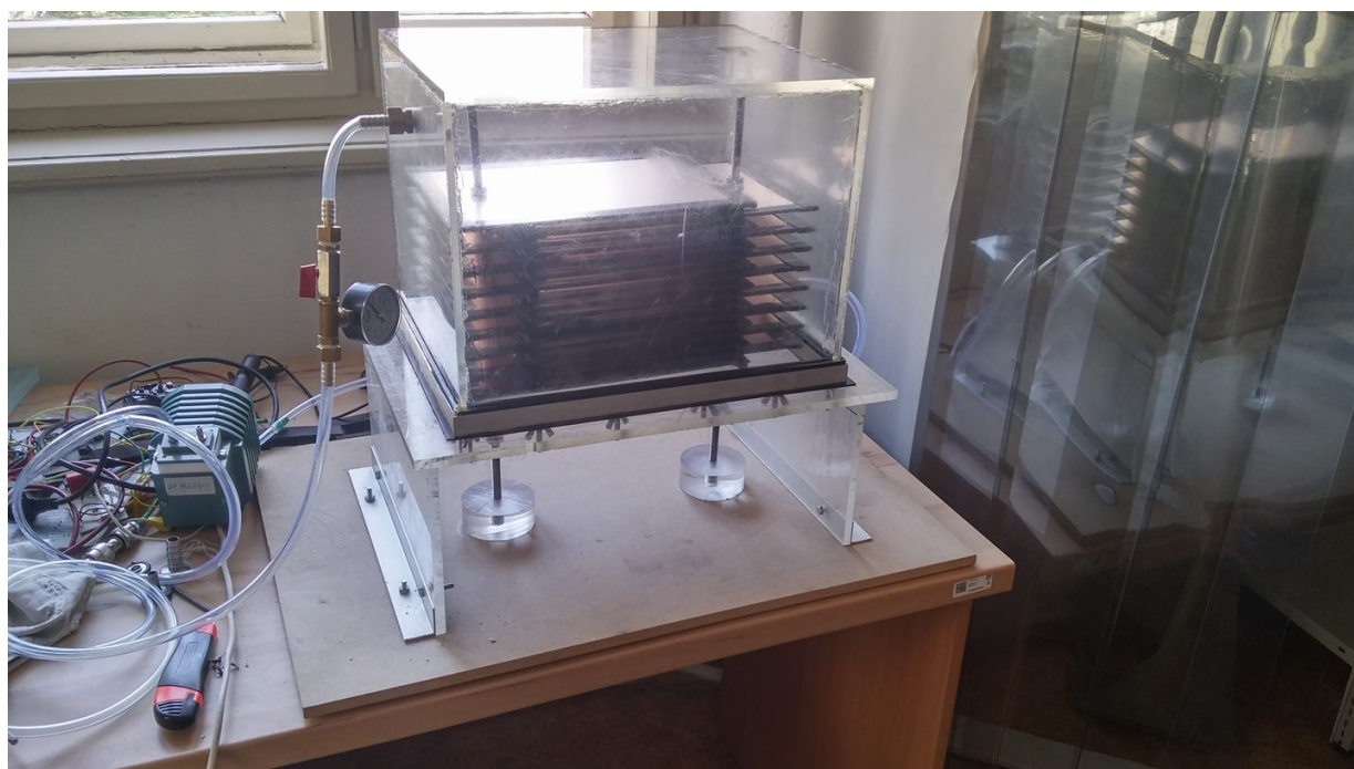
Obr. 2.2: Finální podoba vnější a vnitřní konstrukce jiskrové komory.
