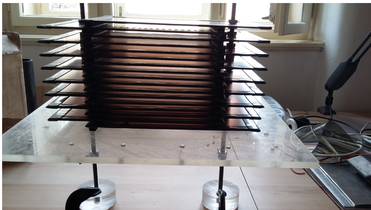
Obr. 2.6: Výsledná konstrukce vnitřní komory.
