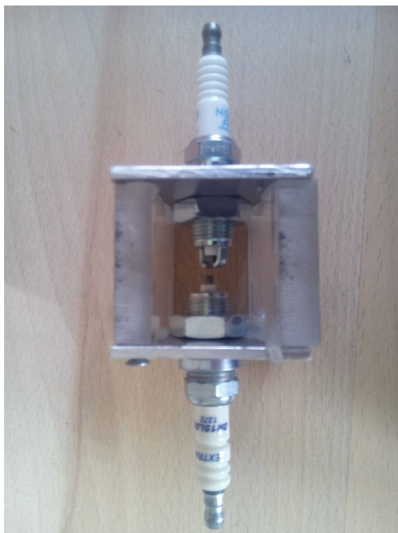
Obr. 3.6: Sestrojené jiskřiště. Jako elektrody slouží střední terminály zapalovacích svíček a jeden vnější terminál svíčky.
