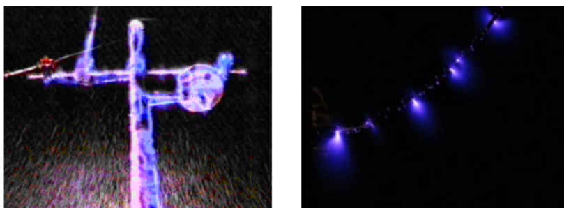
Obrázek 2.3: Fotografie tichých výbojů na sloupu a elektrickém vedení, převzato z [1].
