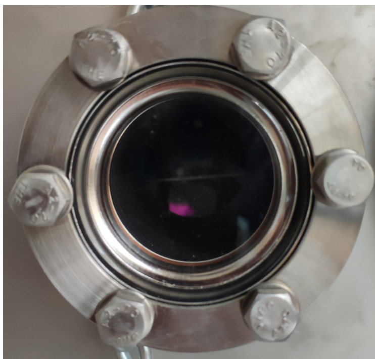
Obrázek 8.1: Fotografie fialového světla při zapojení hlavní urychlovací elektrody v konfiguraci se stínítkem.
