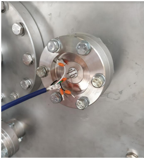
Obrázek 6.3: Test připojení USB kabelu na průchodku kf40 vakuové komory.
