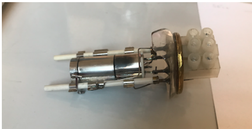
Obrázek 3.1: Elektronové dělo z osciloskopu s jedním urychlovacím kanálem.
