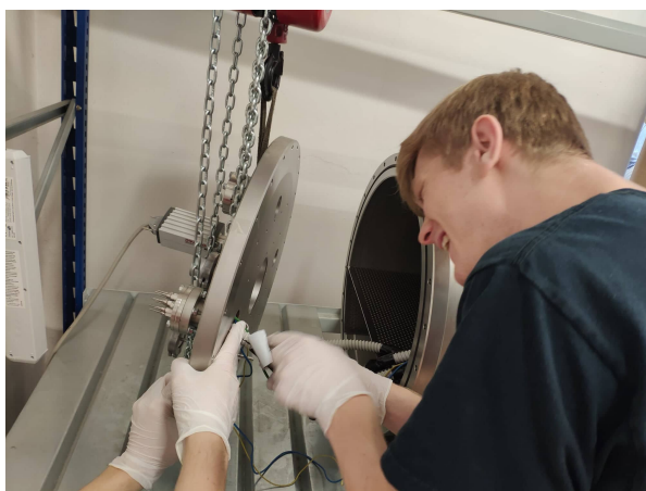
Obrázek 4.2: Po vložení děla do komory jsme kontakty připojili na průchodku.
