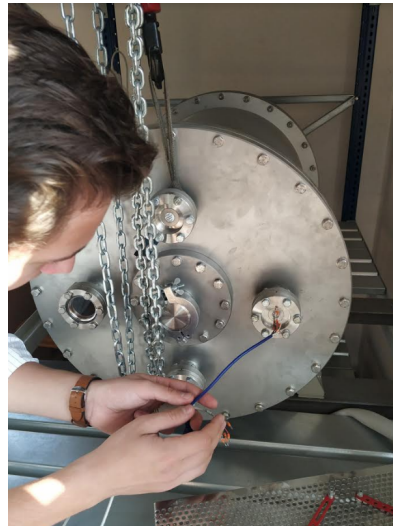
Obrázek 6.3: Test připojení USB kabelu na průchodku kf40 vakuové komory.
