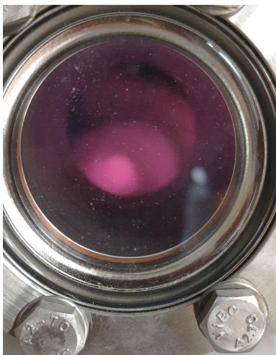
Obrázek 8.2: Fotografie fialového světla při zapojení hlavní urychlovací elektrody v konfiguraci bez stínítka.
