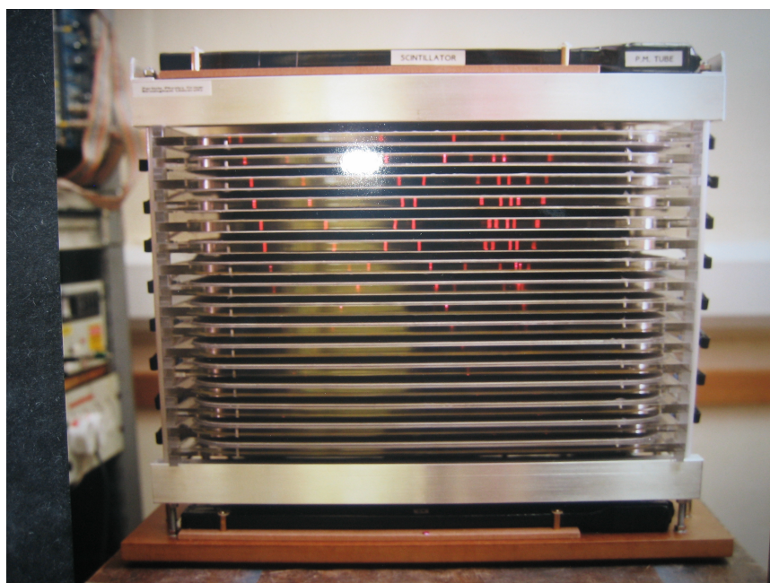
Obrázek 1.2: Jiskrová komora s kvádrovou konstrukcí vyrobená na Univerzitě v Birminghamu [2].
