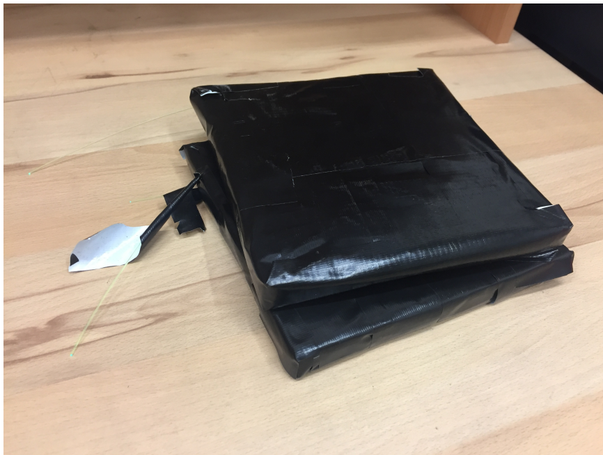
Obrázek 3.2: Scintilátory s WLS vlákny.
