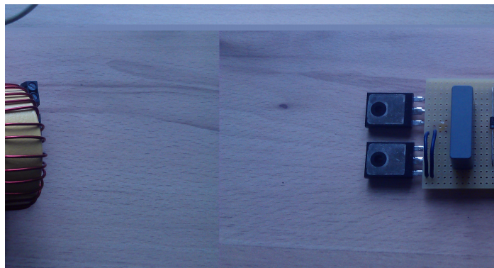
Obr. 4.2: Řídící obvod ZVS na flyback transformátor.
