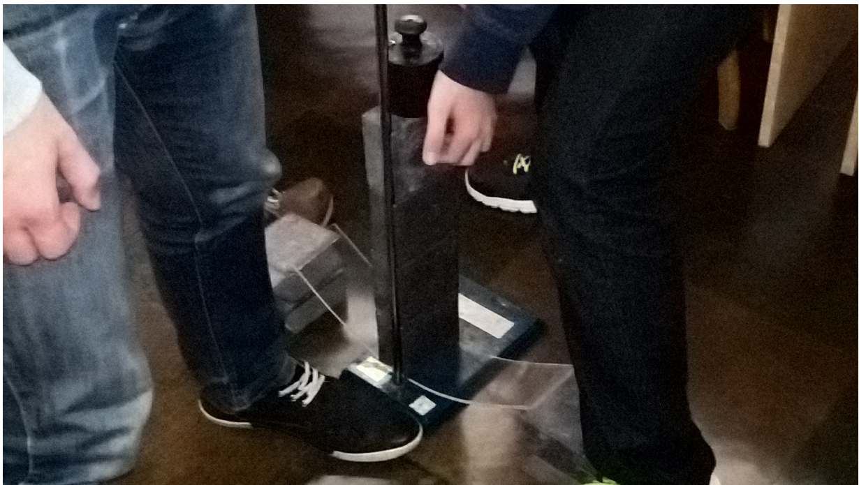
Obr. 2.3: Určování Youngova modulu pružnosti a ověřování výdrže plexiskla - ilustrační fotografie.
