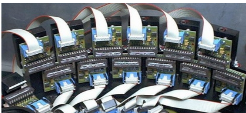
Obr. 16: Rozmístění detektorů CCD v geometrii Paschen-Runge. Převzato z [16].
