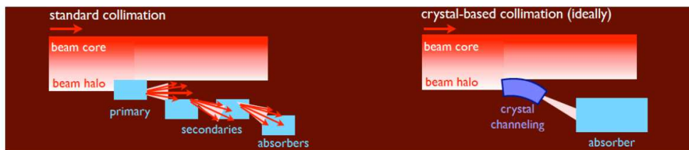
Obrázek 4.7: Porovnání metod kolimace pomocí víceúrovňové metody a pomocí ohnutých krystalů. Převzato z Ref. [36].
