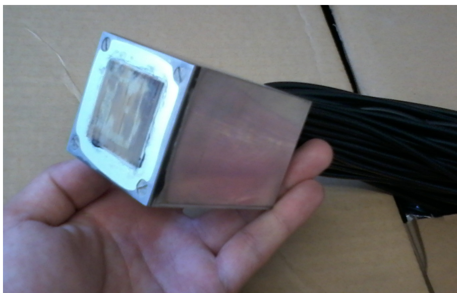
Obr. 3.4: Optická matica spája veľké množstvo opticky čistých vlákien a vytvára vyčítaciu plochu, ktorú sníma kamera.
