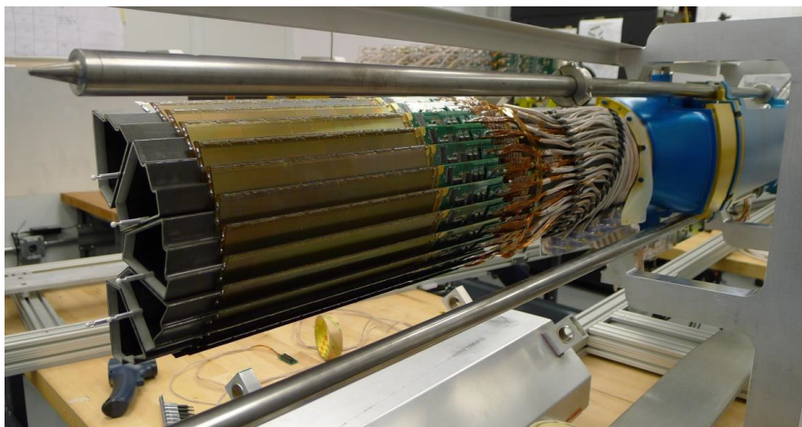
Obrázek 5.11: Konstrukce Pixelového detektoru. Sektory jsou šedé barvy a nachází se na nich žebříky s detektory, na konci jsou vyvedeny kabely pro vyčítání. Převzato z Ref. [37].
