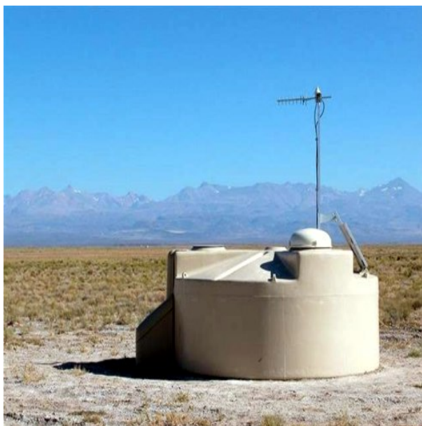
Obrázek 4.2: Čerenkovský detektor, jedna z nádrží naplněná destilovanou vodou, používaná na projektu AUGER.
