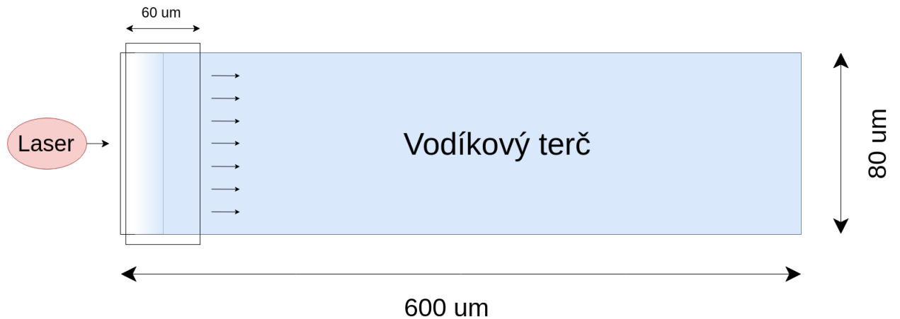
Obr. 9: Schematické znázornění prostoru simulace s posouvajícím se s časem okénkem.
