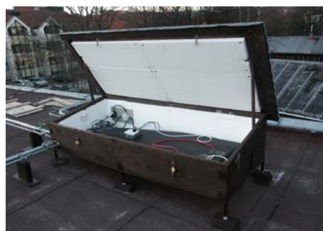
Obr.26 – Jeden ze scintilačních detektorů umístěných uvnitř venkovního krytu.
