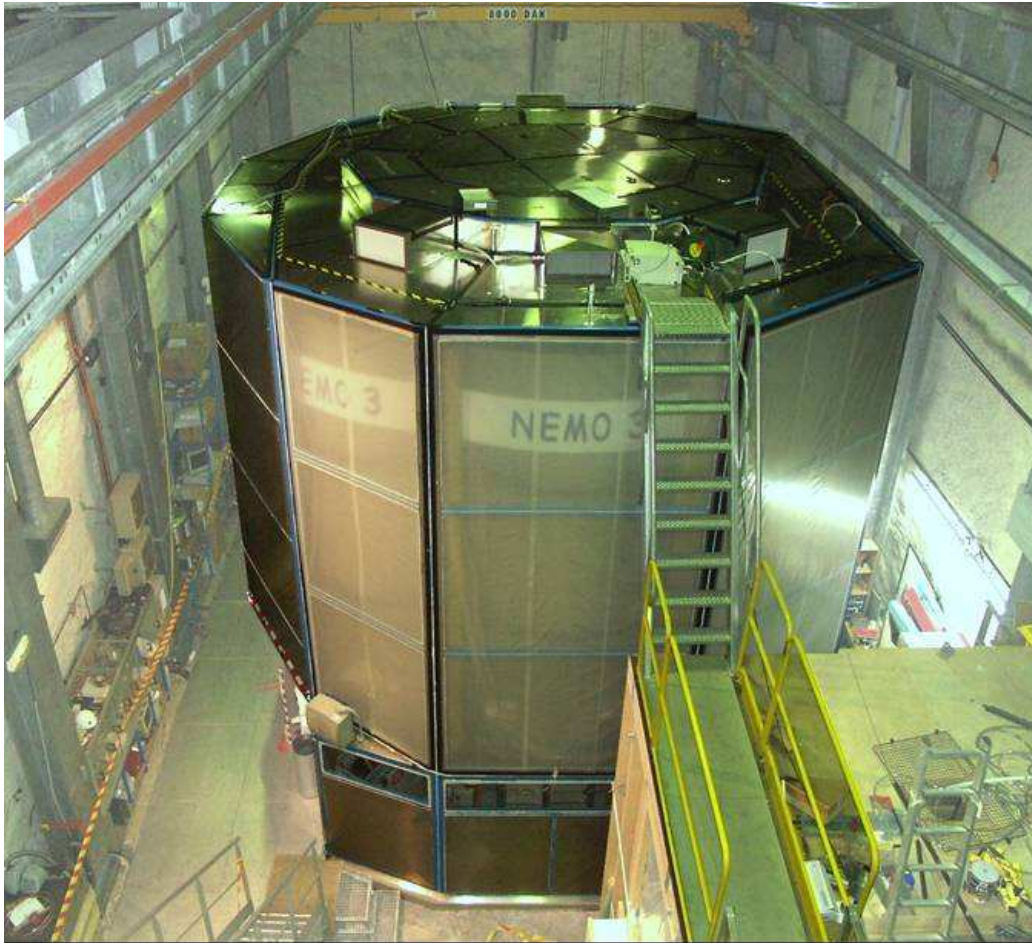
Obrázek 27: Vzduchotěsný obal detektoru NEMO 3 proti radonu.
