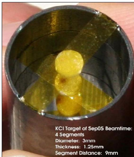
Figure 4.2.: KCl target.
