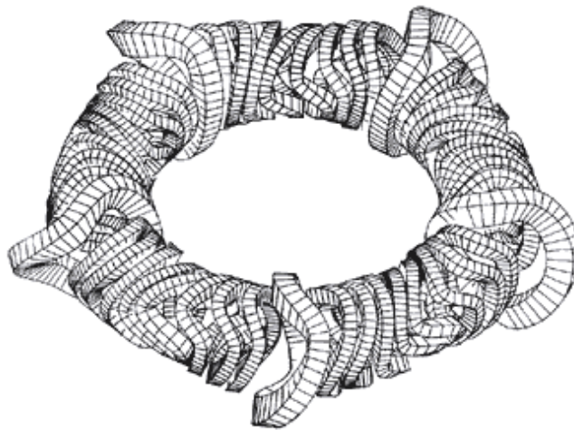
Obr. 1.2: Znázornění složitého uspořádání cívek na stelarátoru Wendelstein 7-AS v německém Garchingu. [31] © Max-Planck-Gesellschaft zur Förderung der Wissenschaften e. V.
