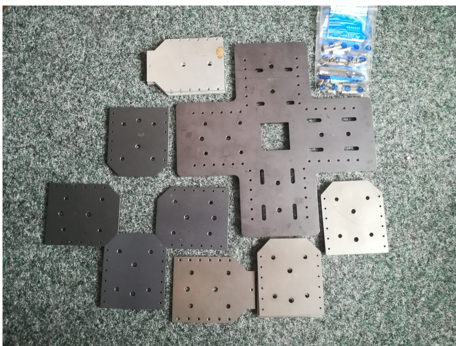
Obrázek 2.9: Díly připravované nosné konstrukce k vytváření sestav detektorů timepix3 u tokamaku Golem.
