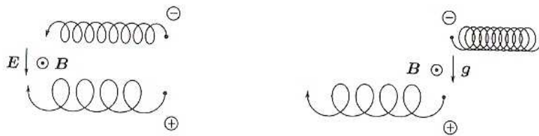
Obr.II. 2: Drift elektrickou silou (vlevo) a gravitační silou (vpravo). [2]
