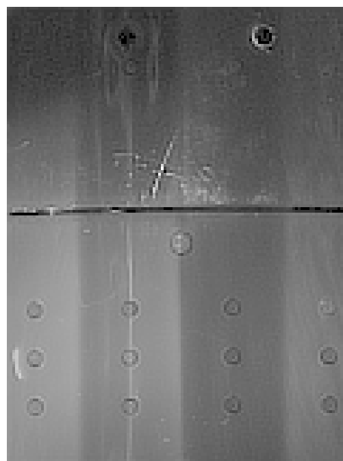
Obrázek 4.16: Výsledek slepé dekonvoluce obrázku 4.13 s inicializační naměřenou PSF (tab. 4.9).
