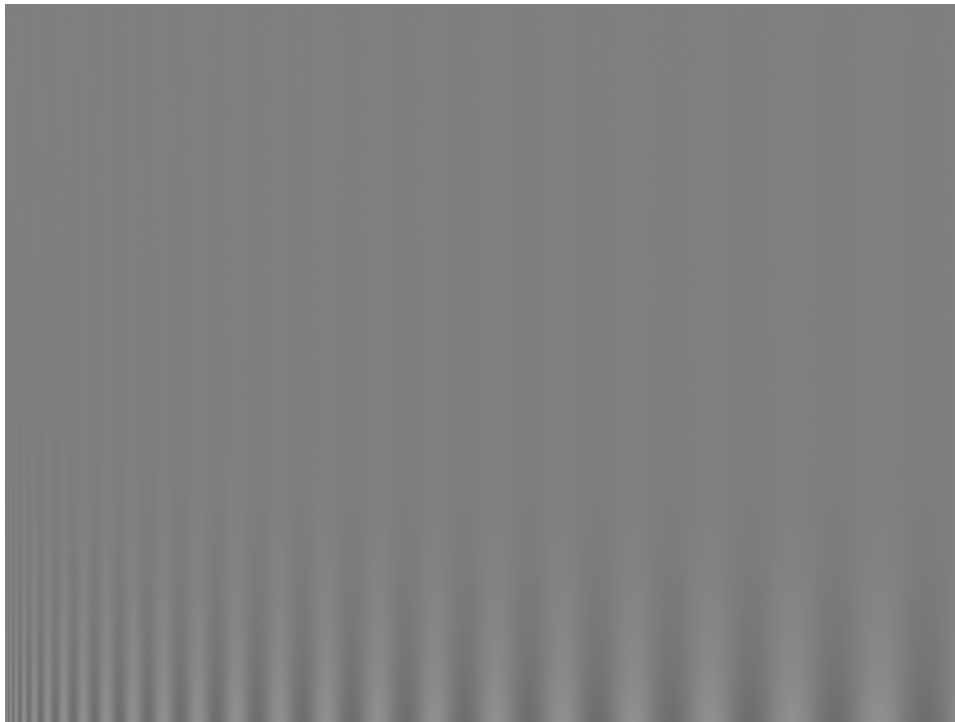
Obrázek 4.5: Ilustrace vlivu prostorové frekvence na vnímání kontrastu. Kontrast roste směrem dolů na vertikální ose, s horizontální osou se sinusoidálně mění prostorová frekvence. [1]
