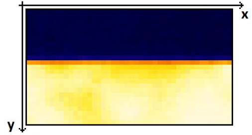
Obrázek 4.8: Snímek skokové změny teploty ve vertikálním směru. Tmavě studená zacloněná oblast, světlě zahřátý objekt.
