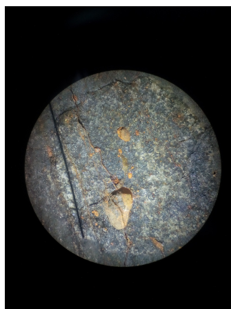
Obr. 5.4: Stopa po výstřelu výkonového jodového laseru Asterix na meteoritu NWA 8212.
