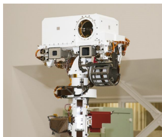
Obr. 7.1: Zařízení ChemCam, které je součástí roveru Curiosity [28].
