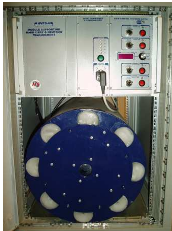
Obr. 3.3: Plastový scintilační neutronový detektor se scintilátorem Bicron BC-408. Bílé válečky rozmístěné na kraji symetricky kolem středu detektoru jsou parafín.
