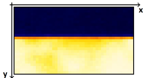
Obrázek 3.15: Snímek skokové změny teploty ve vertikálním směru. Tmavě studená zacloněná oblast, světlě zahřátý objekt.
